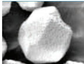
严重的反应-晶体边缘、角落和表面完全丧失
