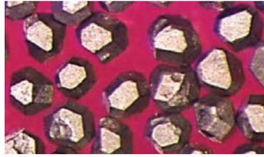
Ti1 涂层提供有效的晶体保护, 防止侵蚀性粘结材料, 增强粘结保持力, 具有高晶体突出度和出色的自由切割能力。
